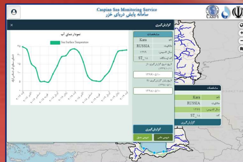
شکل ۶- مقادیر مشاهداتی تراز سطح آب، دمای سطح آب، دمای هوا، شوری و آبدهی رودخانه و اخذ گزارش به صورت نمودار و جدول
